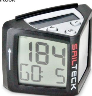
L'allumage se fait automatiquement lorsque vous **DECOUVREZ** le panneau solaire à la **LUMIERE DU JOUR** (à l'intérieur, vous pouvez allumer le panneau solaire avec une lampe ou un portable). Pour éteindre, placez-le sur une table. S'il n'y a aucun mouvement ou soleil, Sailteck s'éteint automatiquement au bout de 2 minutes.
